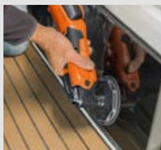
Brúsne listy s molitanovou penou na odstránenie škrabancov napríklad na akryle a polykarbonáte.
