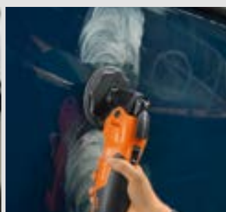
Škrabance v laku vozidla odstránite pistenou leštiacou podložkou a leštiacim prostriedkom.
