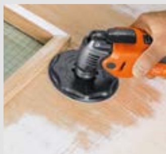
Veľký okrúhly brúsny tanier nahrádza ďalšie brúsny, ako sú napríklad excentrické alebo orbitálne brúsny.
