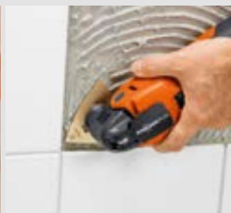
Tvrdokovová rašpka ostraňuje lepidlo na dlaždice a zaisťuje vyrovnaný podklad.
